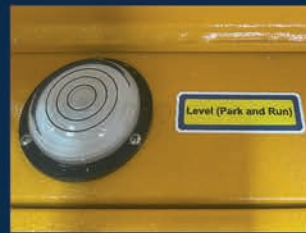
INDICADOR DE NIVEL DE LA TORRE DE ILUMINACIÓN
