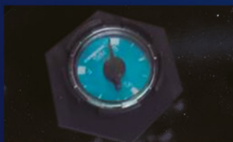
MEDIDOR DE COMBUSTIBLE
