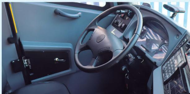
**Cabina del conductor.-** Tablero de control amplio con tacómetro, indicador de velocidad y un panel informativo para ver el nivel de carga y temperatura. Sistema Multiplex para control de funciones del autobús.
