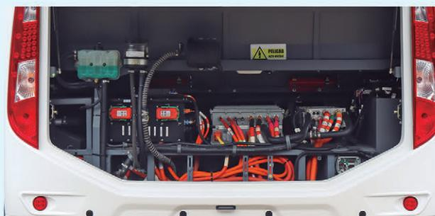
**Sistema eléctrico.-** Cuenta con una capacidad de batería de 200KWh. Autonomía de 200km (carga al 100%) y una potencia de 253 kilovatios. Baterías de Litio-Ferofosfato (LiFePo4).
