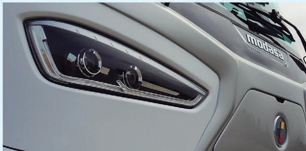
**Faros delanteros.-** Faros principales, luz de día LED y luces antiniebla. Letrero electrónico LED en parabrisas frontal. Faros Stop light, delimitadores y posteriores LED.
