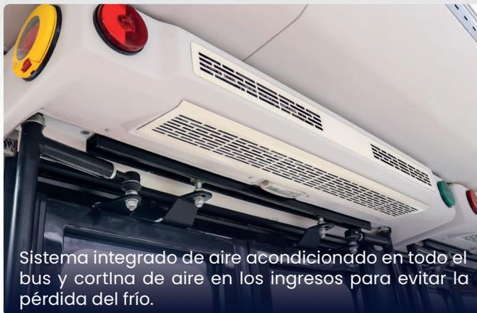
Sistema integrado de aire acondicionado en todo el bus y cortina de aire en los ingresos para evitar la pérdida del frío.
