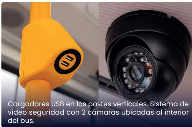
Cargadores USB en los postes verticales. Sistema de video seguridad con 2 cámaras ubicadas al interior del bus.
