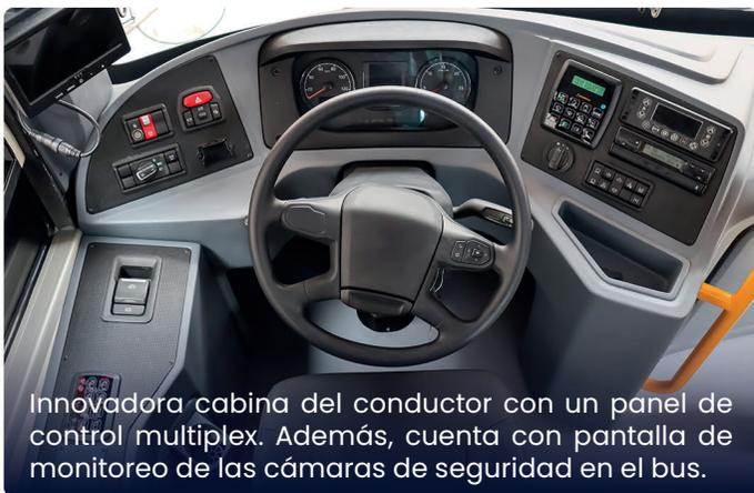
Innovadora cabina del conductor con un panel de control multiplex. Además, cuenta con pantalla de monitoreo de las cámaras de seguridad en el bus.
